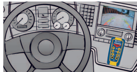
Bär SmartControl chauffeurscabinebesturing (optie) voor de besturing van de Cargolift vanuit de cabine via Bär SmartControl Plus met basisstation. Zie technologieën.
