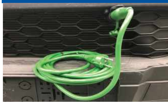
Uitbreiding met een 220 volt nachtkoeling is mogelijk, aansluiting in de cabine of geïntegreerd in de grill van de auto
